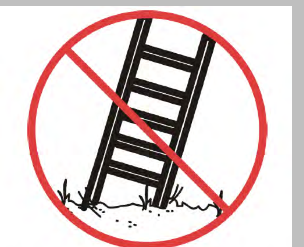
Figure A.7 — Dresser sur une surface solide
