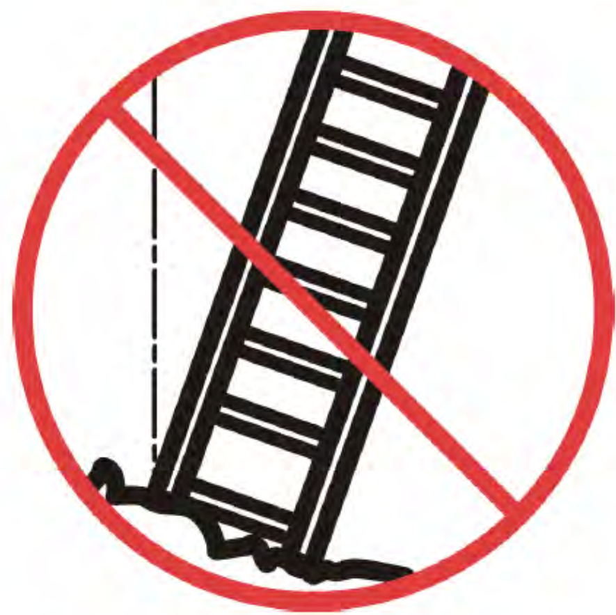
Figure A.4 — Dresser sur une surface plane
